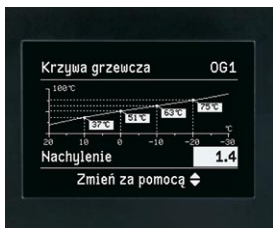
Prosta obsługa regulatora Vitotronic dzięki prowadzeniu użytkownika przez menu i możliwość prezentacji graficznej, np. charakterystyk grzewczych i uzysku energii słonecznej
