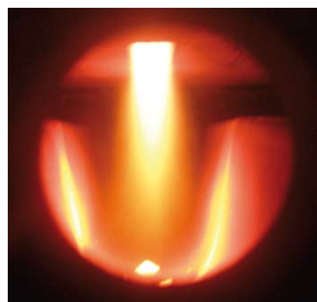
Technika zgazowywania w kotle Vitoligno 100-S
